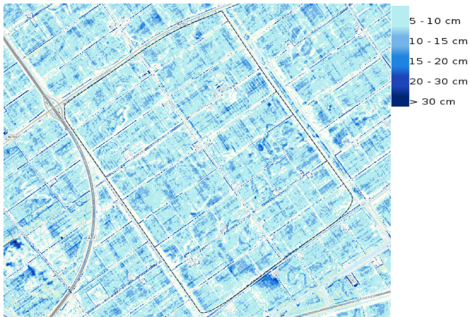
Figuur 3-9: Waterlaag na heftige regenbui (70 mm/2 uur) – Zeewolde Oosterwold
