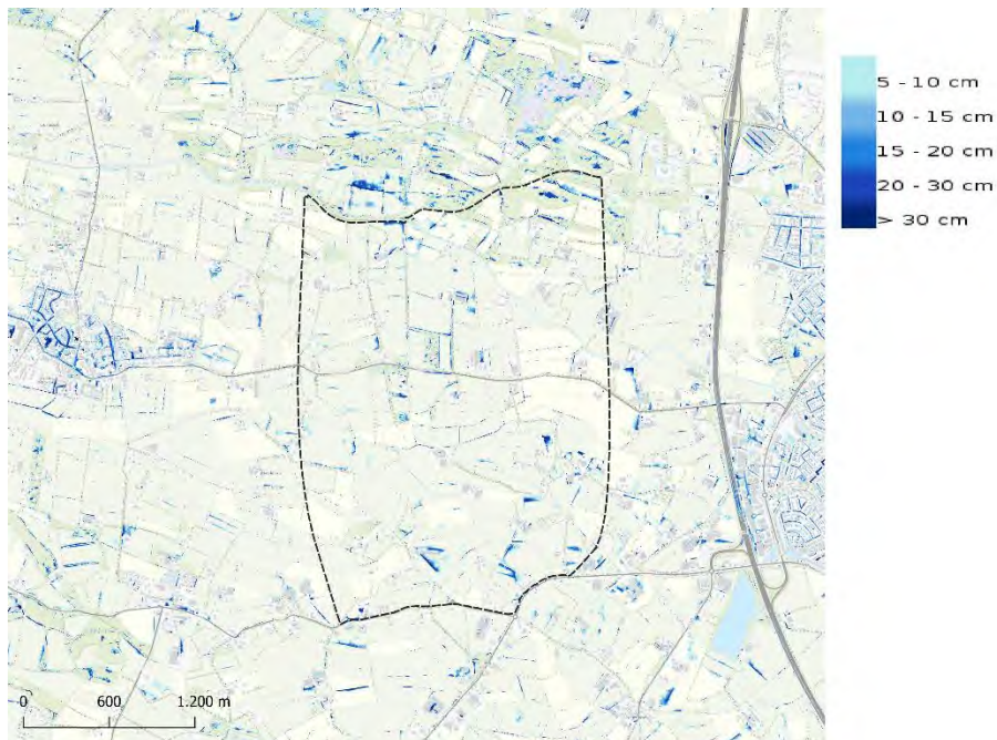
Figuur 3-33: Waterlaag na heftige regenbui (70 mm/2 uur) – Barneveld West
