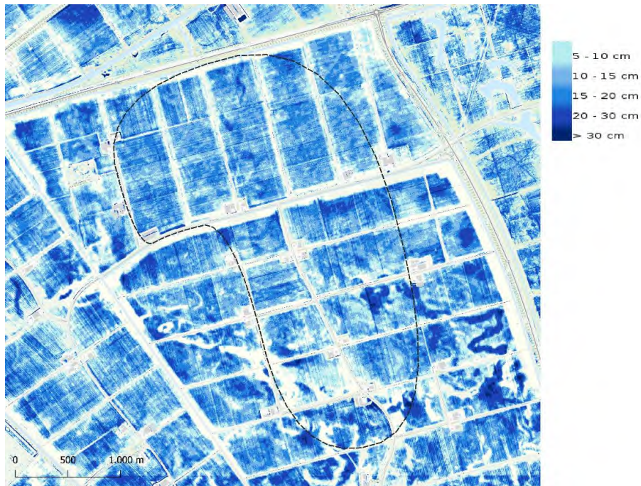
Figuur 7-44: Waterlaag na zeer heftige regenbui (140 mm/2 uur) – Zeewolde Gooiseweg (Bron: Klimateffectatlas)
