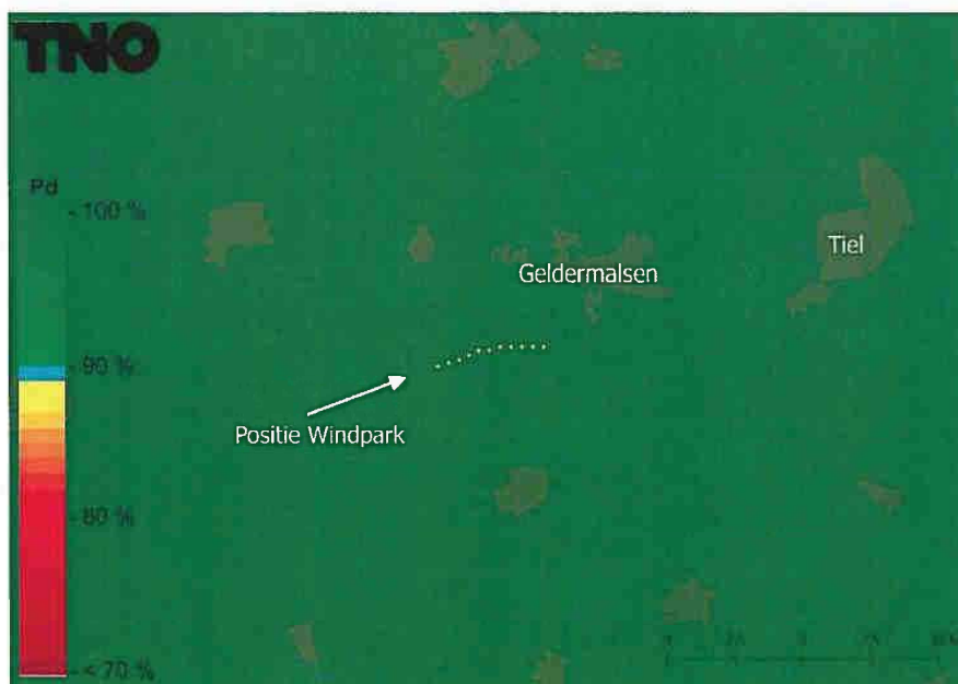
Figuur 6 Detectiekans van het primaire verkeersleidingsradarnetwerk op 1000 voet boven het bouwplan voordat dit is gerealiseerd (baseline). De locatie van de nieuwe windturbines is aangegeven met gele stippen.
