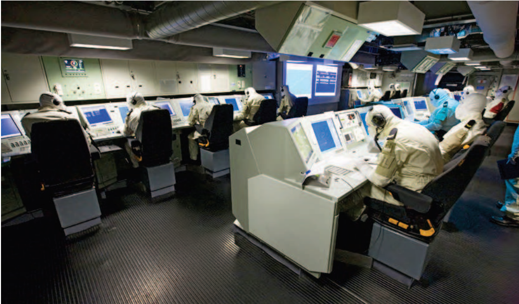
Commandocentrale van een LC-fregat met CMS-consoles
