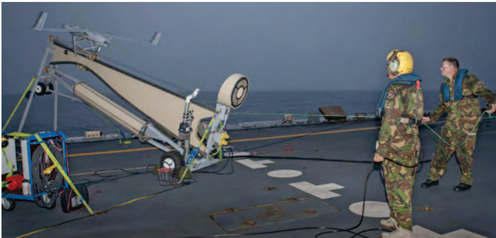
Scan Eagle UAV wordt gelanceerd vanaf het helikopterdek
