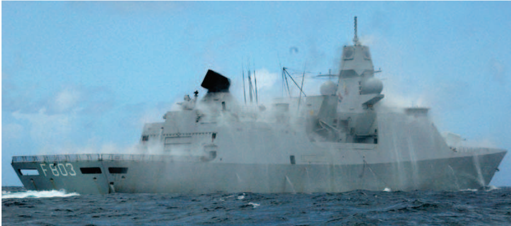
Deksproei-inrichting in werking op een LC-fregat
